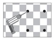
3.1.1 請選擇一幅能承受熱水器的重量 的牆壁或混凝土牆,記下正確的 位置,並用合適螺絲固定裝上牆 壁掛架。
