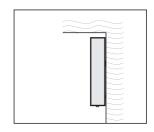
3.1.3 請根據圖示把熱水器垂直 安裝;傾斜度不能大於5 度。
